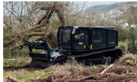
Le macchine per la gestione della vegetazione di Prinoth privilegiano la protezione del suolo e la sensibilità ecologica. La tecnologia di mulching di precisione permette interventi mirati con minima interferenza su vegetazione e radici circostanti. L'uso di cingoli a bassa pressione sul suolo riduce ulteriormente compattazione ed erosione, mantenendo la biodiversità in bordi boschivi, scarpate e corridoi di servizio.
