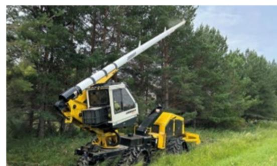
La nostra gamma di macchine per la cura degli alberi Jarraff è stata sviluppata con al centro l'eco-efficienza. I telai a bassa pressione al suolo preven- gono la formazione di solchi e la compattazione del terreno durante l'uso, soprattutto su terreni sensibili o umidi. Queste macchine sono progettate per garantire massima precisione, consentendo potature mirate che riducono le interferenze inutili con gli alberi e la vegetazione circostante.
