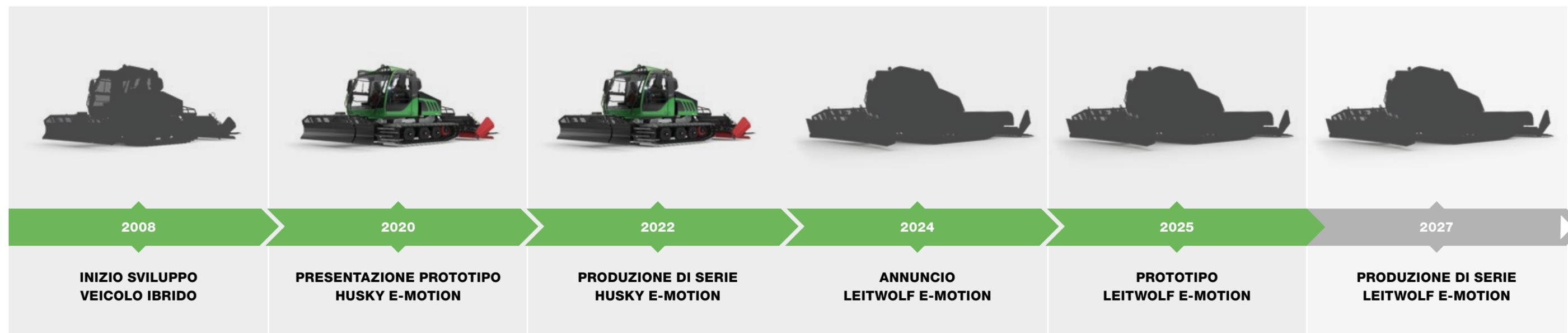
Le radici di Prinoth nello sviluppo di veicoli elettrici risalgono al 2008, quando fu realizzato il primo battipista ibrido del settore come progetto pilota. L'Husky E-Motion ibrido combinava una trasmissione diesel-elettrica, riducendo il consumo di carburante del 20%.
